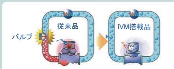
インバータにて回転速度を調整することで流量を最適化し、ポンプの消費電力を削減。
